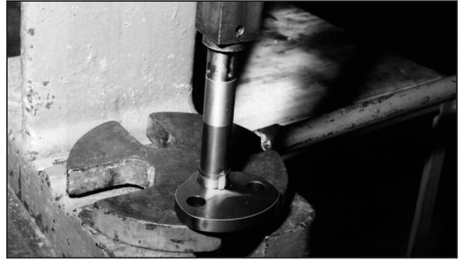
**Figure 14 – Insérer l'arbre dans la came**
