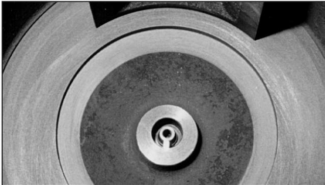
**Figure 17 – Installer le cône et la clavette de blocage de l'arbre dans la douille**
