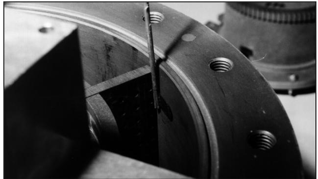
**Figure 20 – Mesurer le dégagement aux extrémités des palettes**
