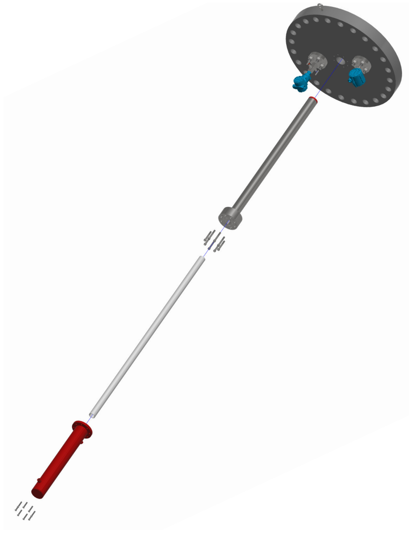
Figura 5.7 - Remova o tubo do conjunto de parada
