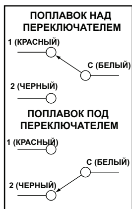
Рисунок 7. Электромонтаж герконового переключателя ORS Положение контактов показано для обоих состояний переключателя в зависимости от положения магнитного поплавка
