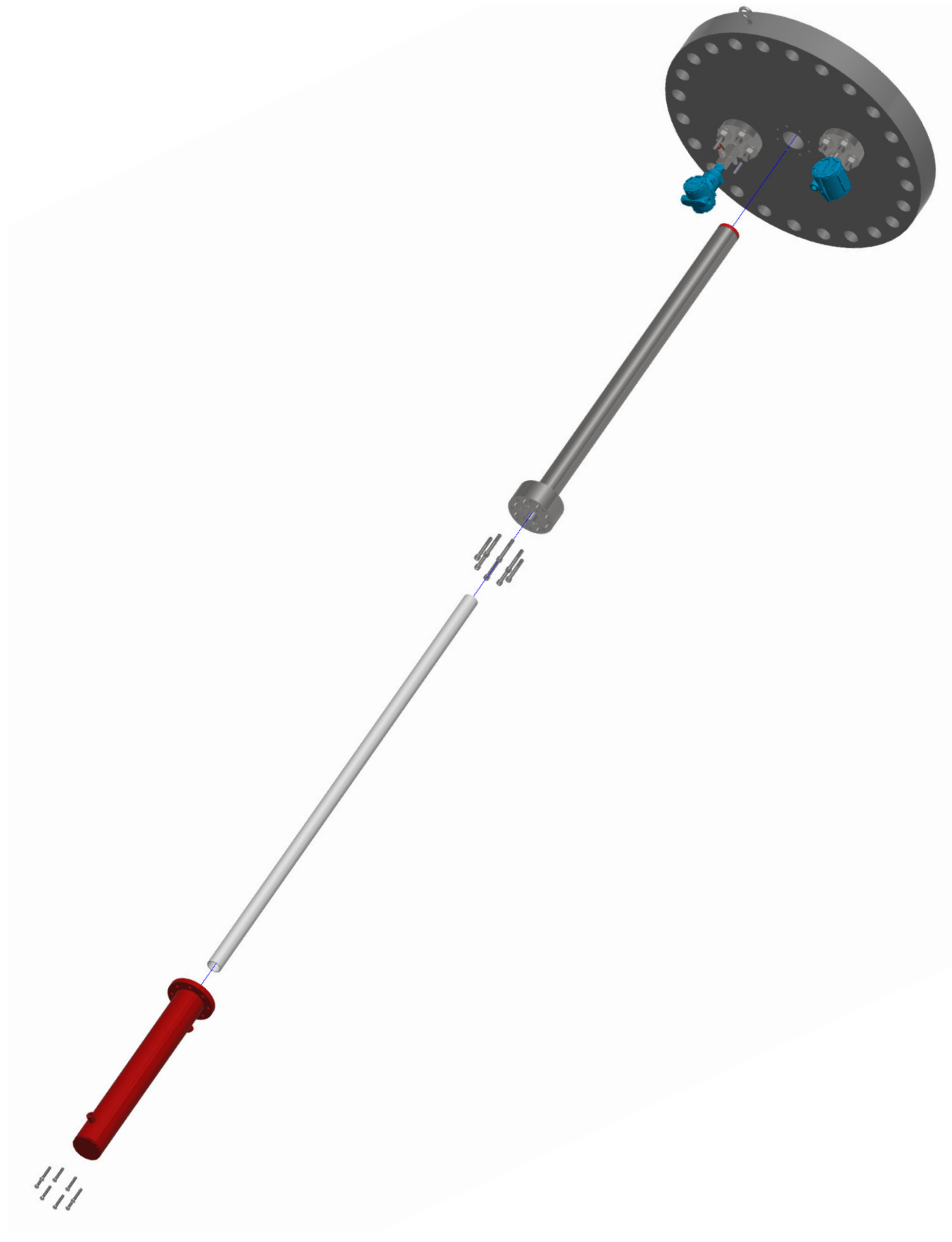
Рисунок 5.7 – Демонтаж трубки стопорного узла
