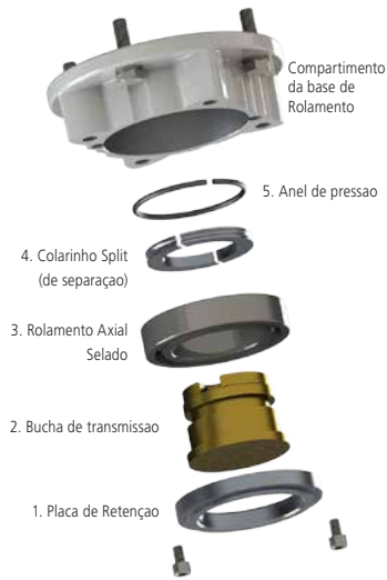
Fig. 5.1.2 Montagem da base F10
