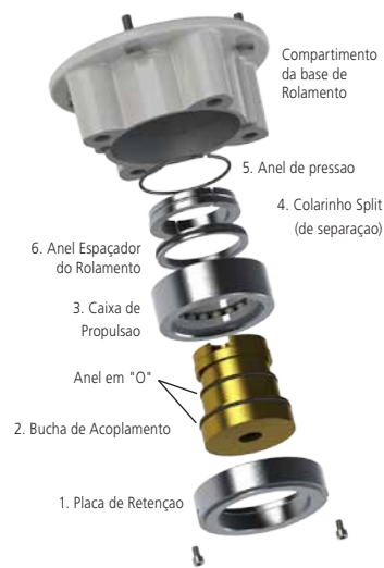
Fig. 5.1.3 Montagem da base F14 e F16
