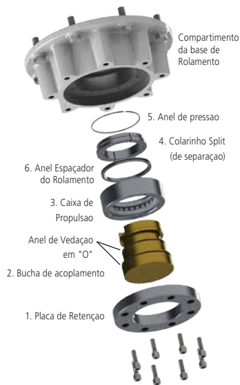
Fig. 5.1.4 Montagem da base F25 e F30
