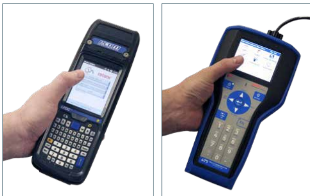
Figura 1. Esquerda: ECOM, Direita: Rosemount 475. O CVA pode ser configurado usando um dispositivo habilitado para Bluetooth sem fio, como um computador ou um comunicador HART de oficina típico como ECOM ou Rosemount 475
