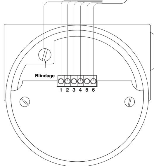
**Remarque:** pour ATEX II 1G / zone 0: le signal mA ne peut être connecté qu'en cas d'utilisation d'une sonde Thermanel d'une épaisseur de paroi de 1 mm.
