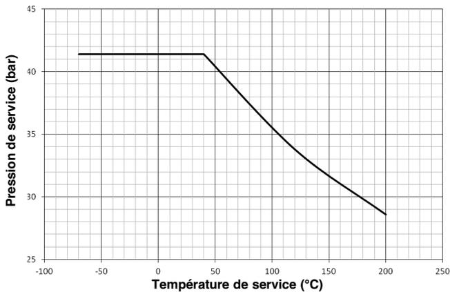
Sondes TMC/TMD avec code matériau A ou D
