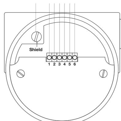
Connexions sonde TD2 électronique déportée
