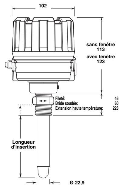
Modèle TD2 avec électronique intégrée
