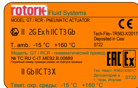
Fig 5.3 Etiquette ATEX/EAC pour hautes températures (-15°C < T < +160°C)
