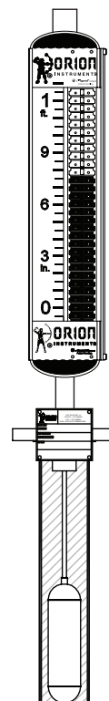
Верхний монтаж указателя уровня Atlas с успокоительным колотцем (обратитесь на завод- изготовитель)
